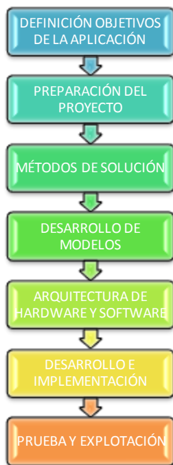
Figura 5-5. Proceso de implementación de un sistema de ESD para la operación en tiempo real.
