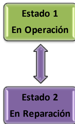
Figura 3-4. Componentes del modelo de dos estados.
